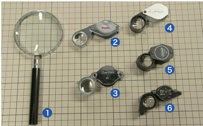
ルーペのいろいろ : 1. 柄のついた「虫めがね」、2. ビクセン M20S (10 倍)、3. カートン光学 R233 (8 倍)、4. Eschenbach 1176-10 (10 倍)、5. BelOMO LP-3-10x (10 倍)、6. カートン光学 カリナン PRO (10 倍) (すべて筆者所有)
